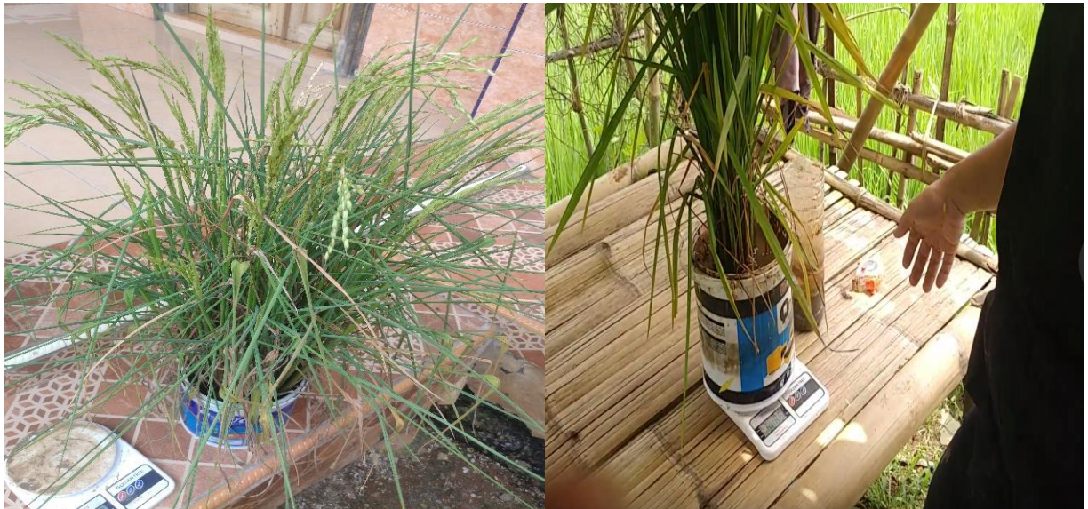
Gambar 5 Contoh pengambilan data evapotranspirasi
